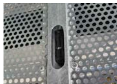
FOTOCPELLULE INSTALLATE IN POSIZIONE CENTRALE DELLA PIATTAFORMA PER GARANTIRE IL FUNZIONAMENTO SOLO CON VETTURA A BORDO
